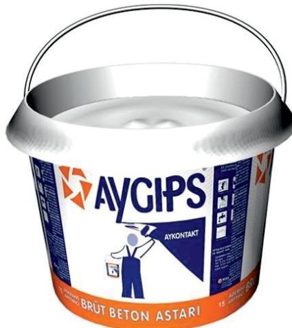
Özellikle kolon, perde, duvar, tavan ve benzeri beton esaslı yüzeylerde alçı öncesi aderans astarı olarak kullanılır. Kuvars kumu katkılı formülü sayesinde alçı ve alçı-kireç esaslı sıvıların beton yüzeylere yapışma dayanımını kuvvetlendirir.
